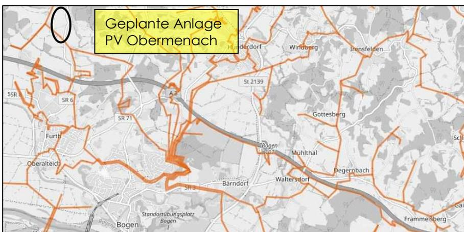
Übersichtskarte freie Netzkapazitäten im Mittelspannungsnetz für Anlagen von 750 kW bis 3000 kW.
